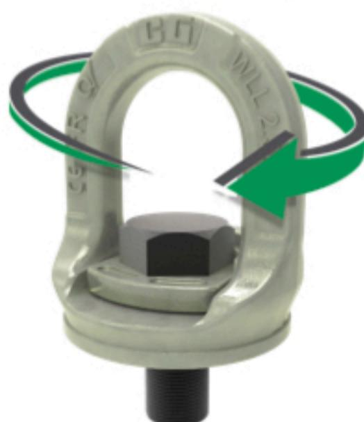
クロスビーの新しい SL-150 スライドロック™ には、標準のアイボルトにない特徴があります。新しい設計の注目点は、ボルトをロックするだけの素早い取付が可能なロックの仕組み（特許取得済）で、スライドを戻すと吊り上げ準備ができます。道具は不要です。
