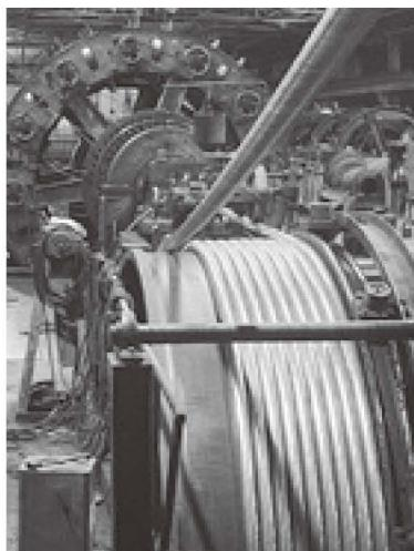
ロックドコイル専用大型より線機
