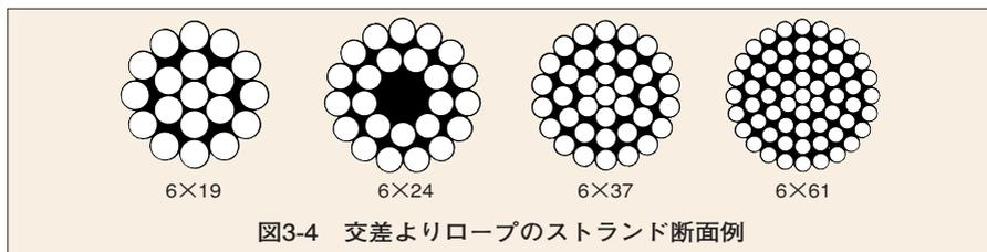
図3-4 交差よりロープのストランド断面例
