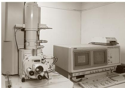
FE-SEM (電界放射型走査電子顕微鏡)
