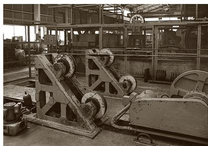
S曲げ・ロープ疲労試験装置
