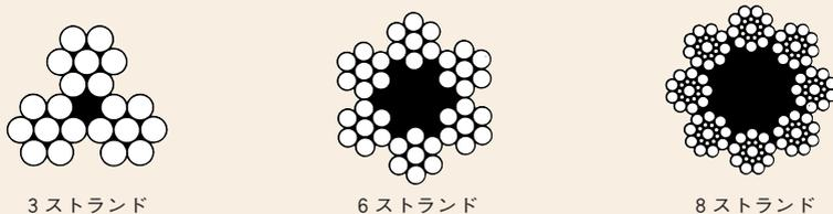
図3-2 ストランド数別ワイヤロープの断面例
